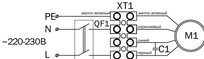
XT1 - клеммная колодка; C1 - конденсатор;
