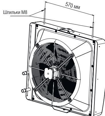
**Горизонтальное подключение:** резьбовые монтажные отверстия (4 шт.) предусмотрены на задней панели аппарата. Для монтажа обогревателя посредством монтажных шпилек необходимо вкрутить шпильки M6 через вытяжные гайки предусмотренные в корпусе (вид А) и закрепить их посредством шайбы, гайки и гровера. Шпильки вворачивать в вытяжные гайки до упора в переднюю часть корпуса на глубину L примерно на 67мм .
