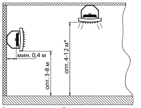
\*при горизонтальной установке направляющих
