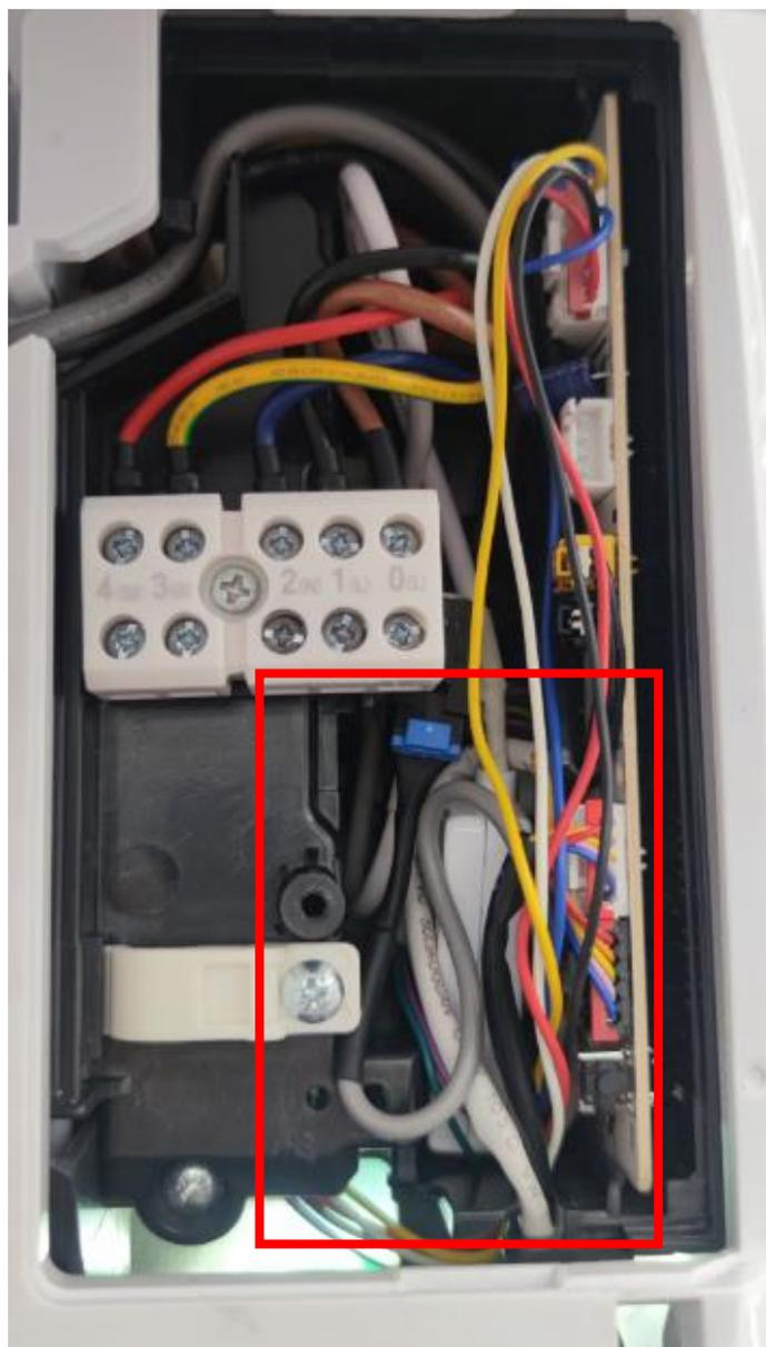
6. Закройте блок электроники крышкой, закрутите крепежный винт крышки блока электроники, закройте переднюю панель кондиционера и подключите кондиционер к сети электропитания. Можно переходить к настройке подключения кондиционера к сети Wi-Fi (пожалуйста, обратитесь к комплектной инструкции модуля Wi-Fi).
