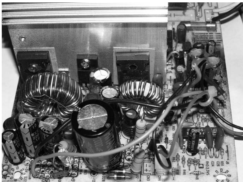
Рис. 5.5. Вид печатной платы с установленными диодными сборками, подлежащими замене
