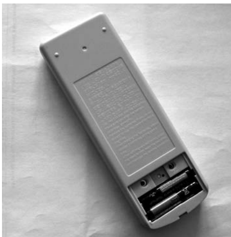
Рис. 3.19. Вид на пульт со стороны отсека батарей и кнопку сброса программирования
