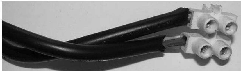
Рис. 5.7. Подключение внешней клеммы к компьютерному БП для мощной нагрузки
